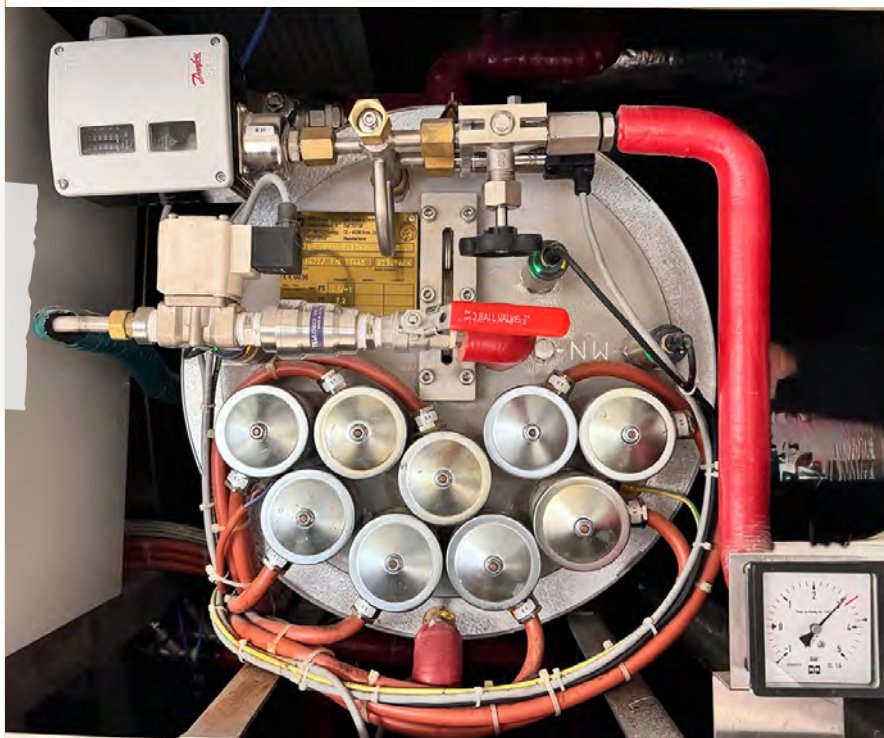
Equipo autogenerador para un autoclave
